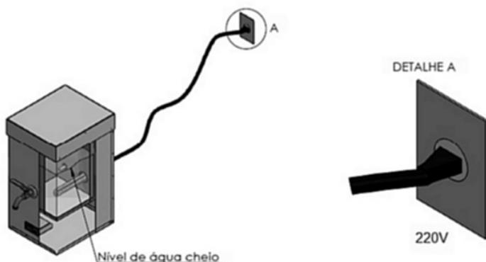
**Nota:** Nunca conecte a Quentuxa na rede elétrica sem que ela esteja com água, sob risco de queima da resistência.
